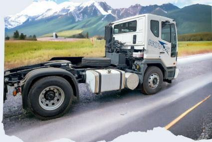
L'acier traité thermiquement à haute résistance maximise la charge utile capacité et durabilité, tandis que les traverses robustes et toutes les techniques de construction boulonnées au cadre assurent une haute efficacité dans la répartition des contraintes de la charge utile sur le châssis.
